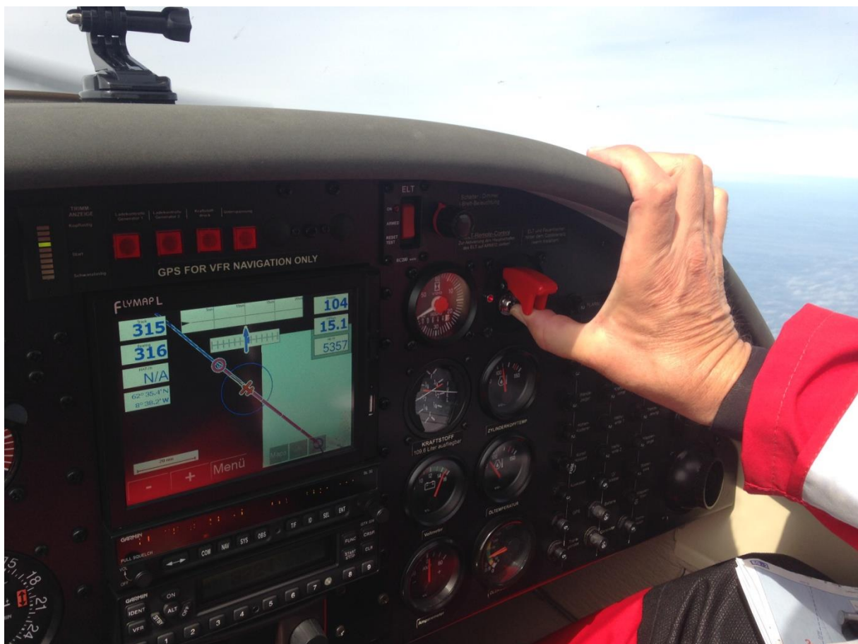
Umpumpen vom Zusatztank in den linken Flächentank
